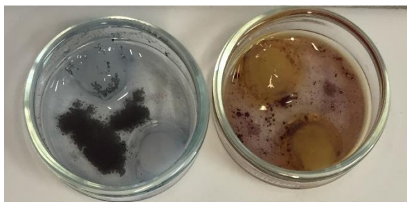
Obrázek 45 - Schopnost solubilizace hydrofobních barviv do struktury chitosanových gelů rozpuštěných v 3 % kyselině octové, zgelované zásaditým roztokem sophorolipidu 10 g/l (foceno po 24 hodinách)
