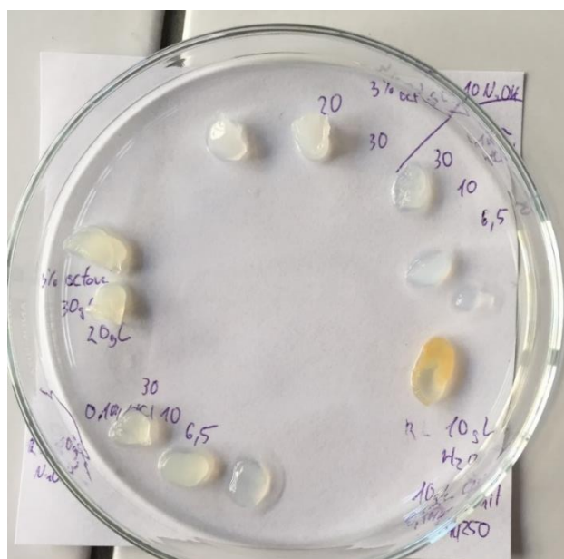
Obrázek 37 – Některé z gelů připravených pro studium reologických vlastností – vizuální porovnání (v levém spodním rohu se nachází koncentrační řada chitosanu v kyselině octové, v pravém dolním rohu poté v kyselině chlorovodíkové – obojí síťováno roztokem rhamnolipidu; v horní části se nacházejí gely síťované pouze pomocí pH – 0,5 M NaOH)
