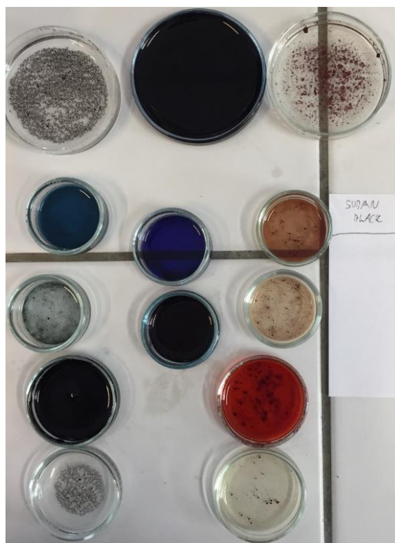
Obrázek 41 - Rozpustnost jednotlivých barviv v různých roztocích (vlevo súdánská černě, uprostřed methylenová modř, vpravo súdánská červeně; od shora dolů: voda, 10 g/l RL v 0,5 M NaOH, 10 g/l RL ve vodě, etanol, 0,5 M NaOH)
