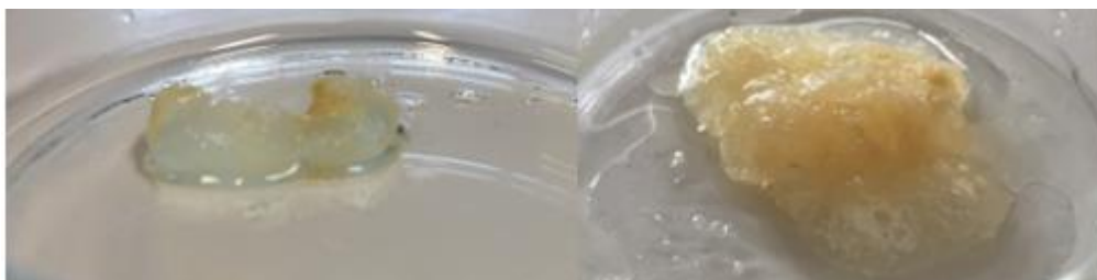
Obrázek 27 - První vytvořené gely (vlevo chitosan do rhamnolipidu, vpravo rhamnolipid do chitosanu)
