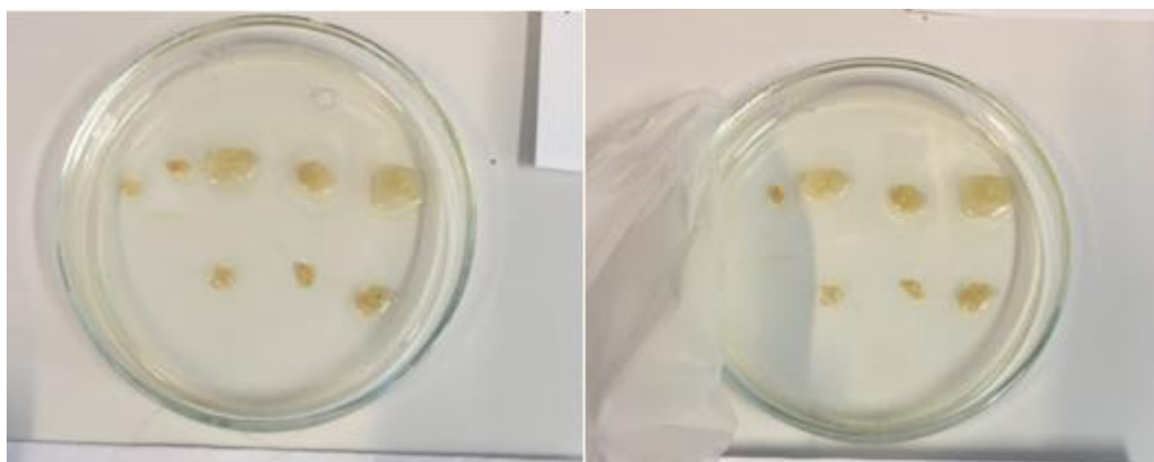
Obrázek 32 - Chitosanové gely po rehydrataci – vlevo 1 hodina po rehydrataci, vpravo přibližně 24 hodin (horní řádek v RL 10 g/l, spodní 20 g/l; zleva koncentrace chitosanu 5; 6,5; 10; 30 g/l)
