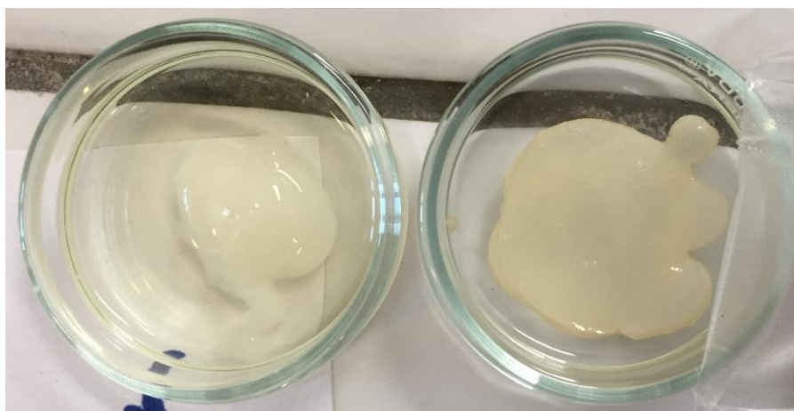
Obrázek 36 - Chitosanové gely vytvořené ve větším objemu (vpravo chitosan v 0,1 M kyselině chlorovodíkové do vodného roztoku rhamnolipidu, vlevo chitosan v 3 % kyselině octové do rhamnolipidu rozpuštěného v 0,5 M hydroxidu sodném)
