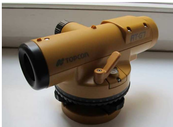
Obr. 10 Nivelační přístroj Topcon AT-G7
