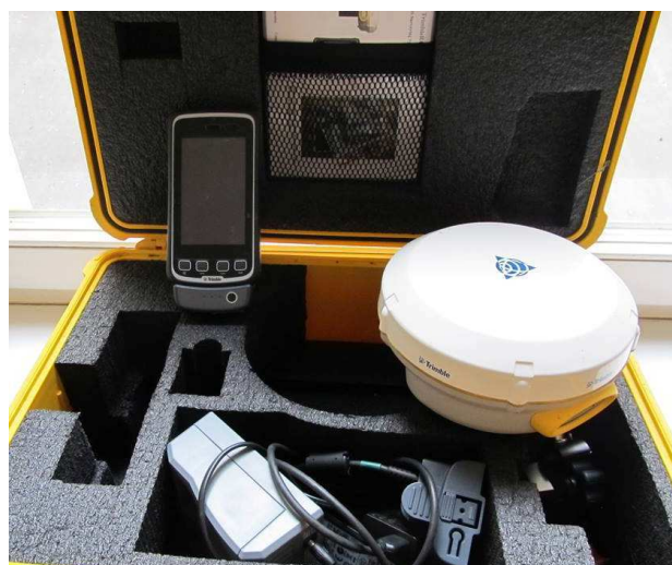
Obr. 13 Použitý GNSS přijímač Trimble R4-3
