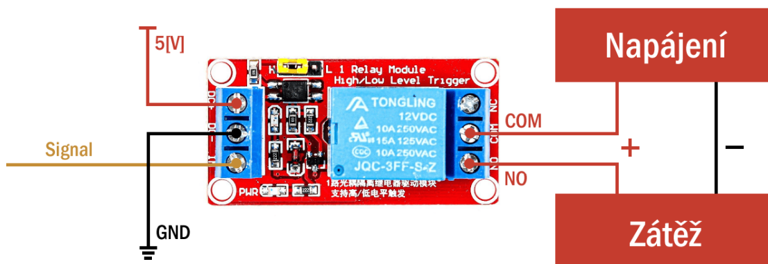
Obrázek 4.12: Schéma zapojení modulu s relé [39]
