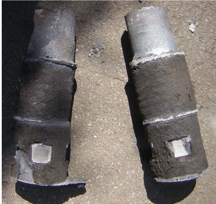
Obr.2.19 Neočištěná zkušební tělesa s nálitky
