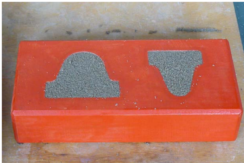
Obr. 2.14 Jaderník se zaformovanými jádry
