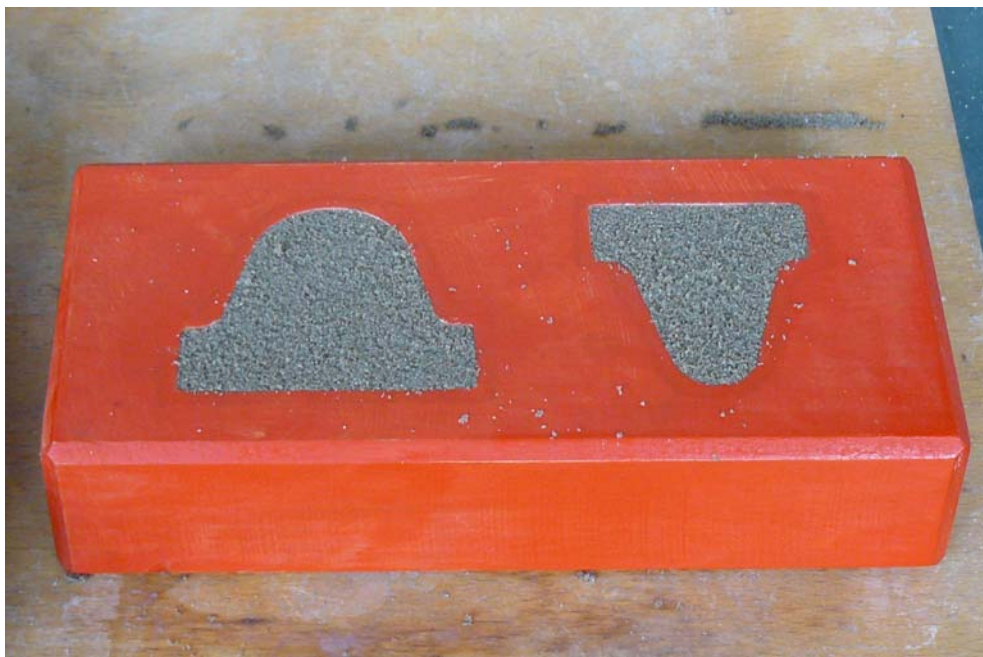
Obr. 2.3 Jaderník se zaformovanými jádry
