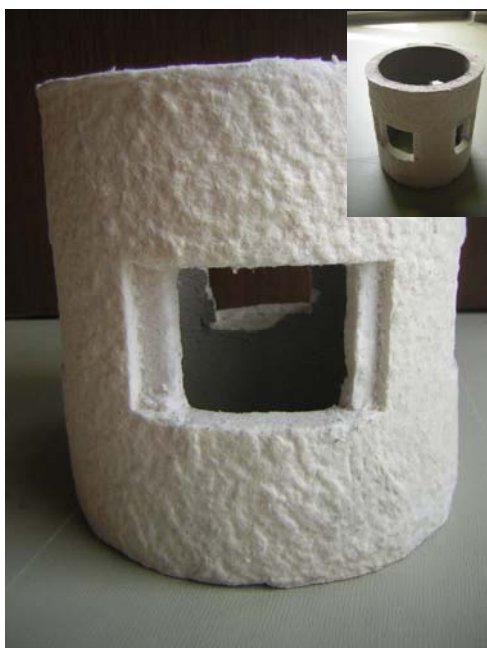
Obr. 2.1 Tepelná izolace zkušebního tělesa
