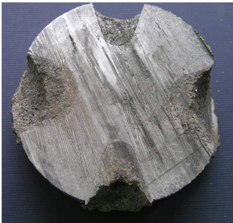
Obr.2.21 Řez zkušebním odlitkem
