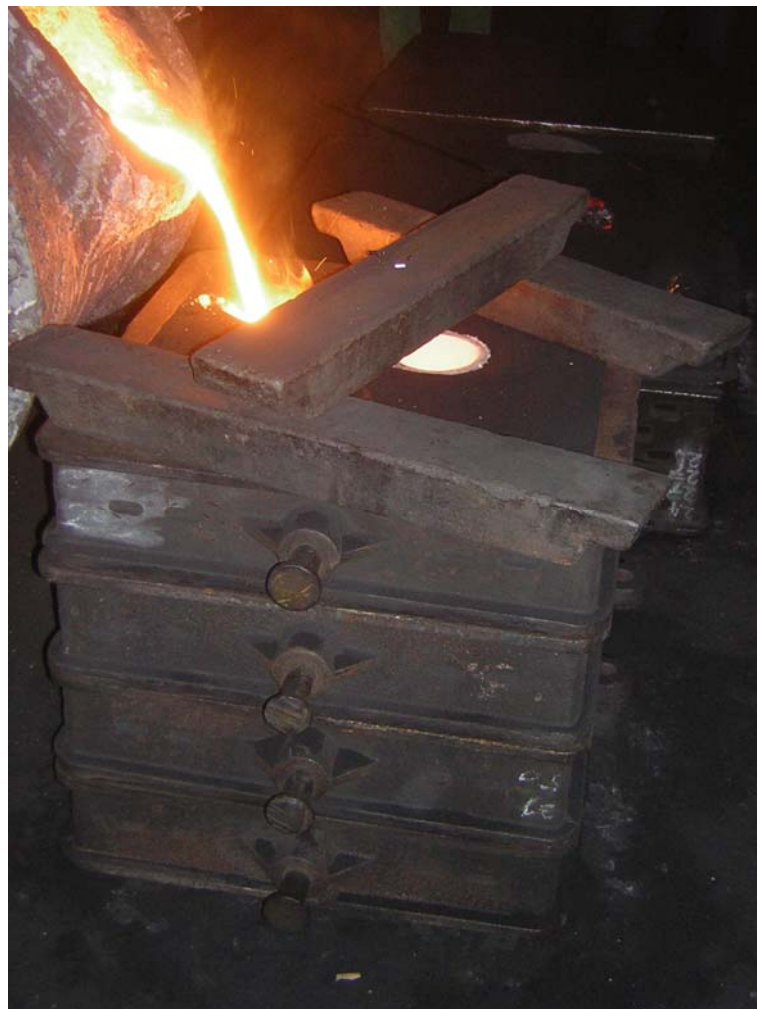
Obr.2.18 Zajištění formy při lití
