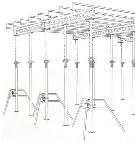
Obrázek 11 Podpěrná konstrukce bednění stropu
