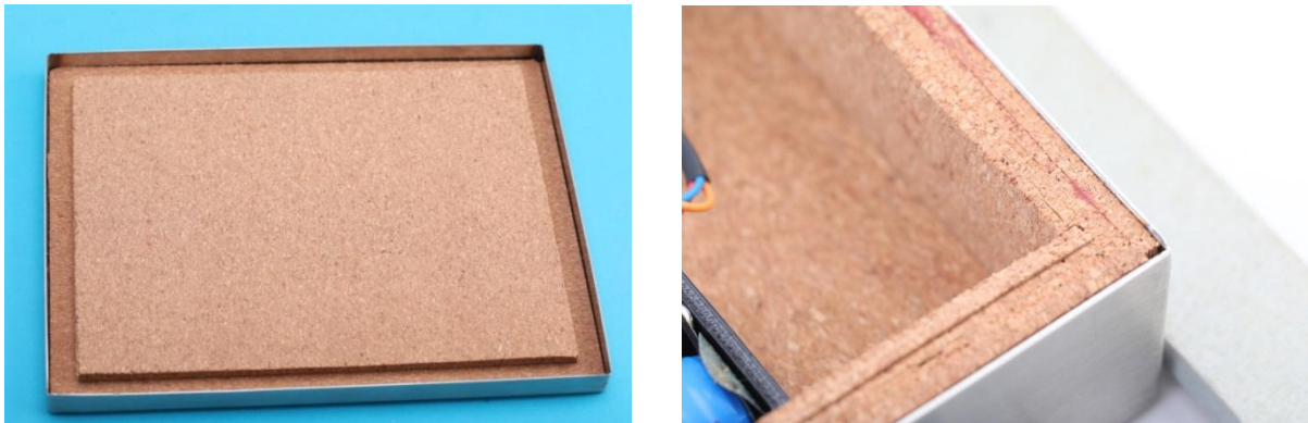
Obr. 5.10: Řešení izolace měřicího boxu
