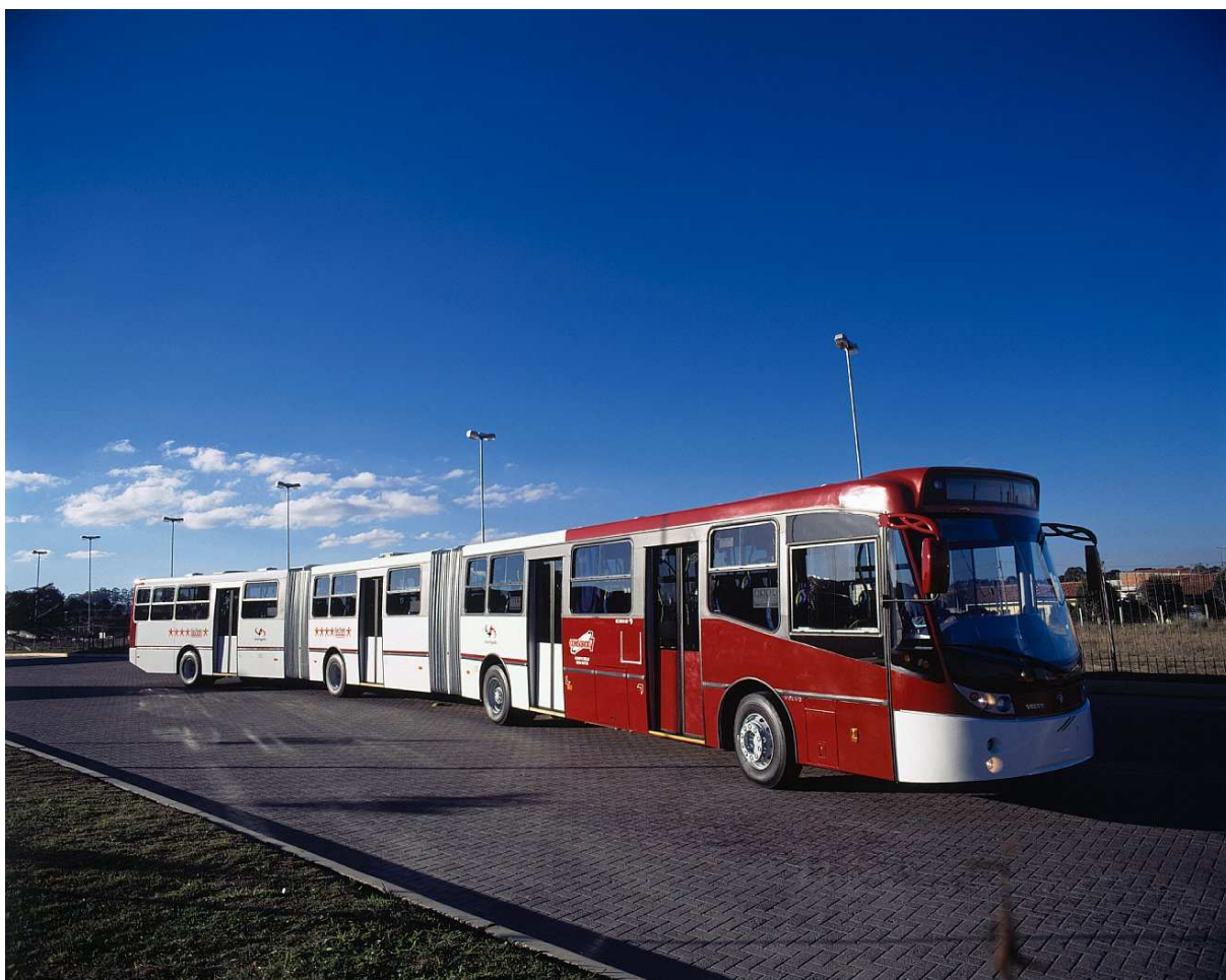
Obr. 2.3 Volvo B12 M o celkové délce až 26,8 m [22]
