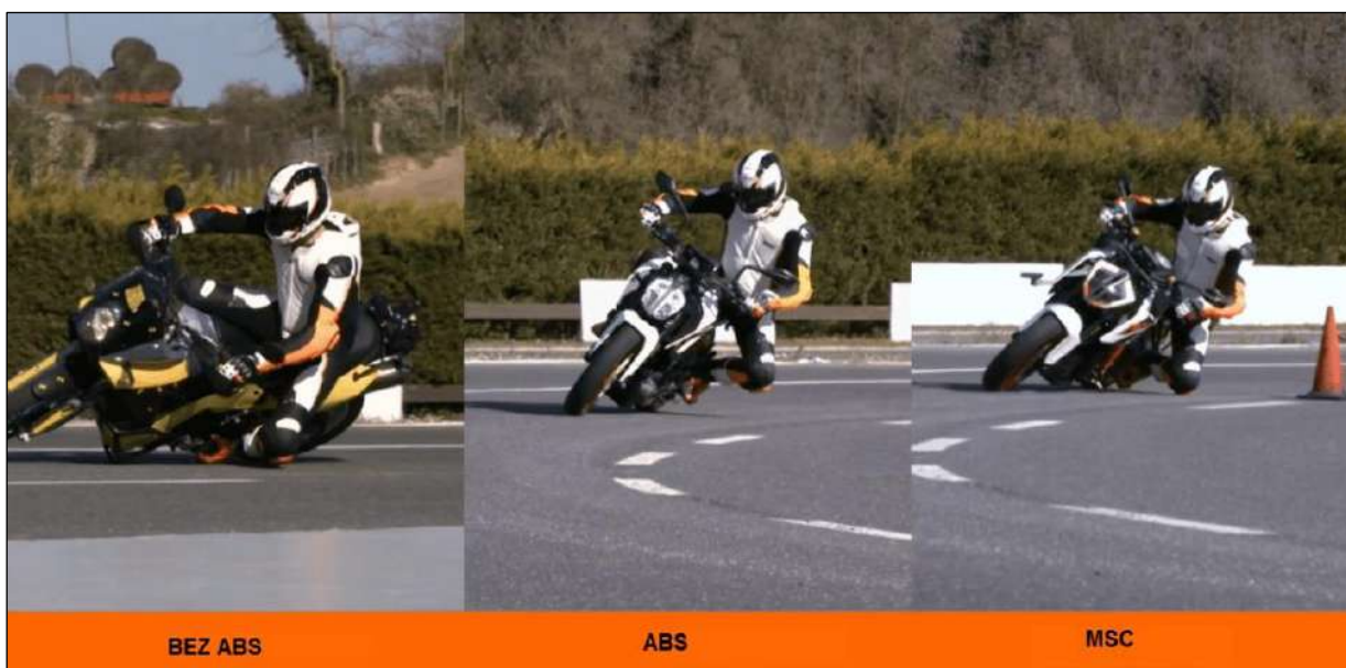
Obr. 32 Rozdíl při průjezdu zatáčkou s užitím bez ABS, s ABS a s MSC [54]
