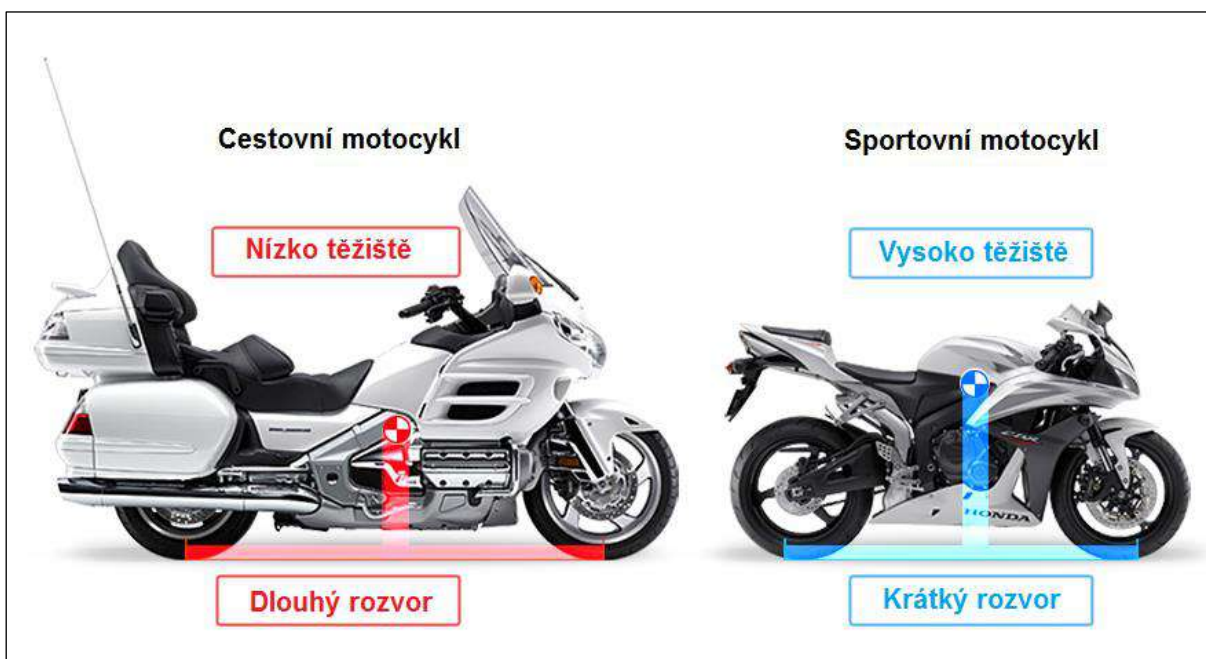
Obr. 28 Příklad umístění těžiště motocyklů [43]
