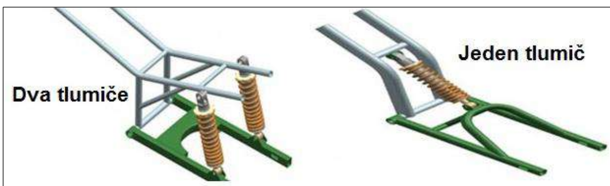
Obr. 15 Odpružení zadní vidlice motocyklu [25]
