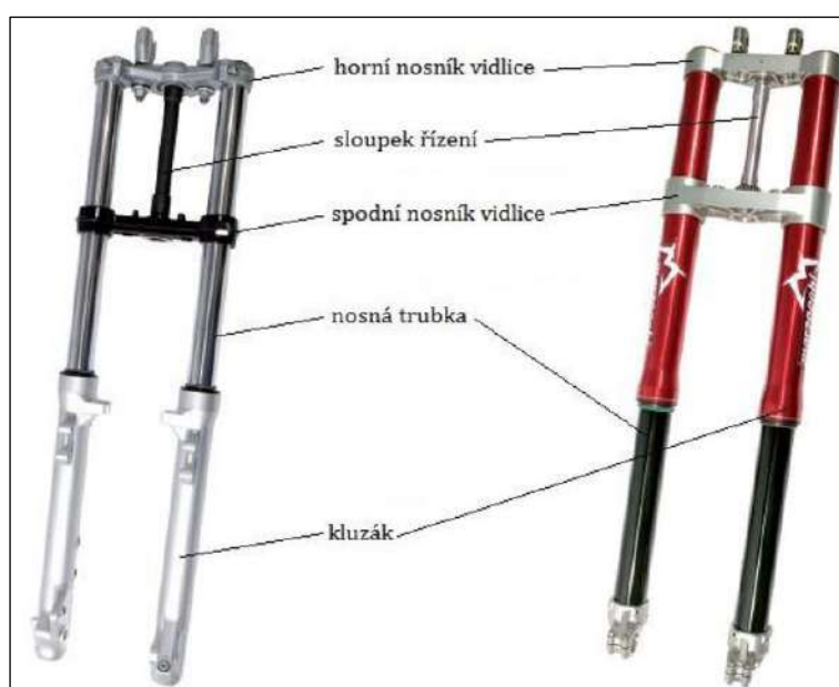
Obr. 14 Teleskopická vidlice (vlevo) a vidlice „upside-down“ (vpravo) [24]
