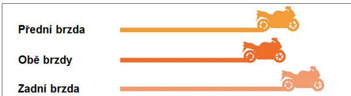
Obr. 30 Závislost brzdné dráhy na použití přední, zadní a obou brzd [43]
