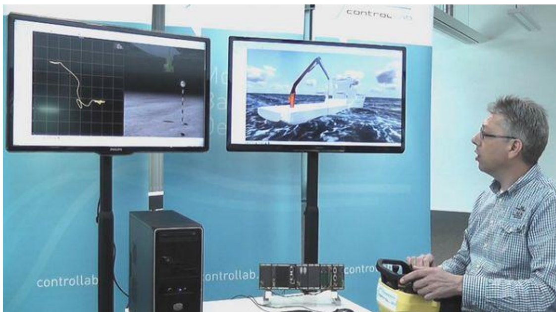
Obrázek 2.10: HIL simulátor jako testovací trenažér [13]
