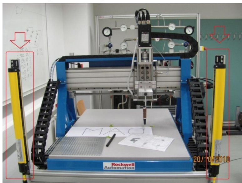
Obrázek 6: Optická závora manipulátoru
