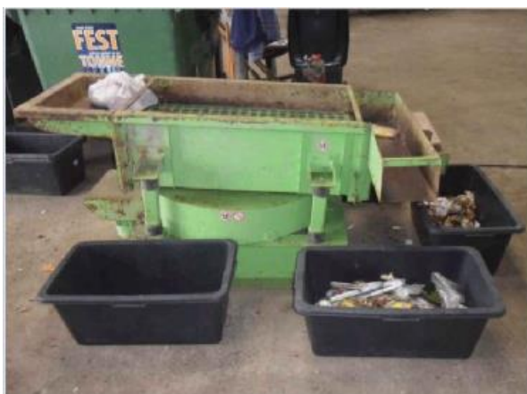
Obrázek 7 Třídění za pomoci vibračního síta [61] Obrázek 8 Třídění za pomoci bubnového síta [31]
