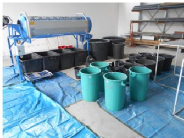
Obrázek 7 Třídění za pomoci vibračního síta [61] Obrázek 8 Třídění za pomoci bubnového síta [31]
