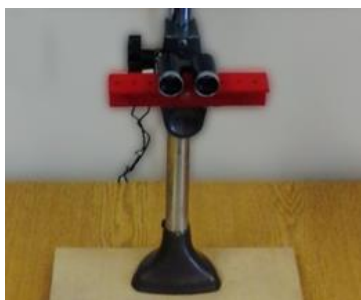
Obrázok 2: Zhotovený súosový stereoskopický kamerový systém
