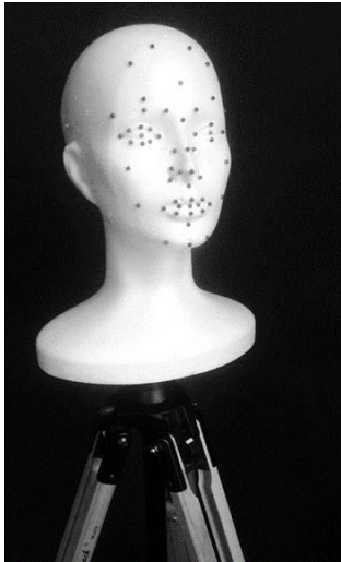
Obrázok 10: Maketa ľudskej hlavy s vyznačenými príznakovými bodmi
