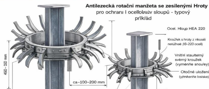
Obrázek 62: Antilezecká rotační manžeta se zesílenými hroty – schematické znázornění principu ochrany sloupů proti šplhání, vlastní zpracování – vytvořeno pomocí generativního nástroje AI, (zdroj: 101)
