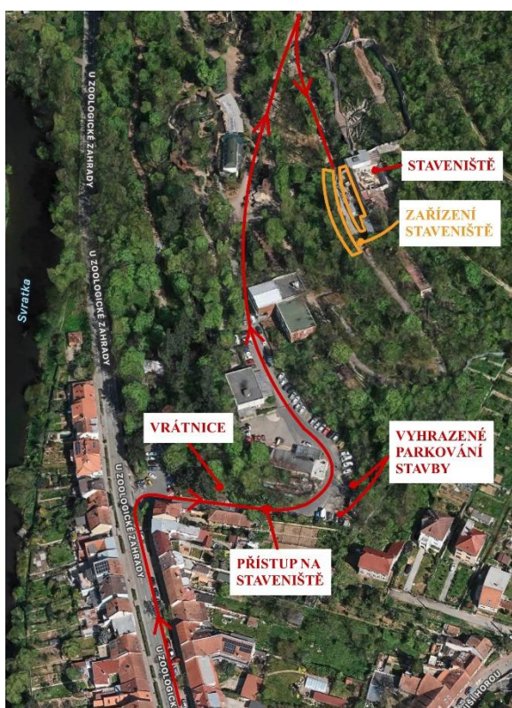
Obrázek 2: širší situace stavby, ilustrativní obrázek (zdroj: 2) Obrázek 1: bližší situace stavby, ilustrativní obrázek (zdroj: 1)
