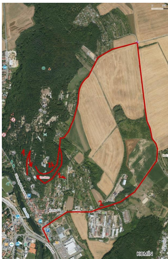
Obrázek 10: trasa samotného jeřábu CC1908 (1) a alternativní trasa návozu a manipulace s materiálem (2a + 2b), ilustrativní obrázek (zdroj: 10)
