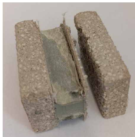
Obr. 24 Porušení podkladního materiálu zkušebního vzorku
