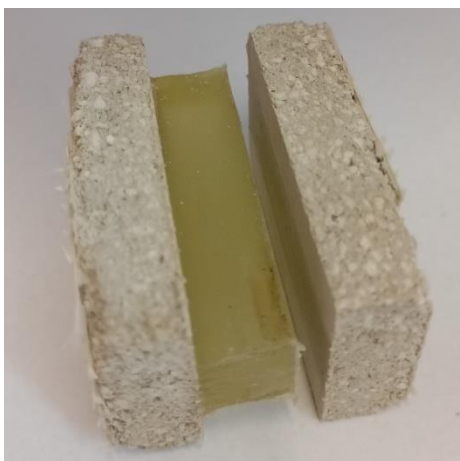
Obr. 23 Adhezní porušení zkušebního vzorku
