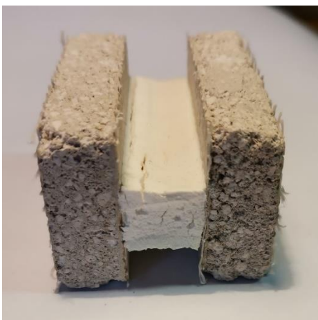
Obr. 25 Kohezní porušení zkušebního vzorku
