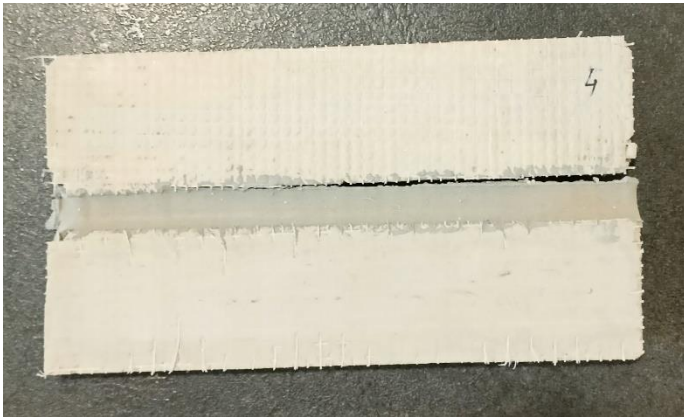
Obr. 26 Adhezní porušení zkušebního vzorku reálné spáry
