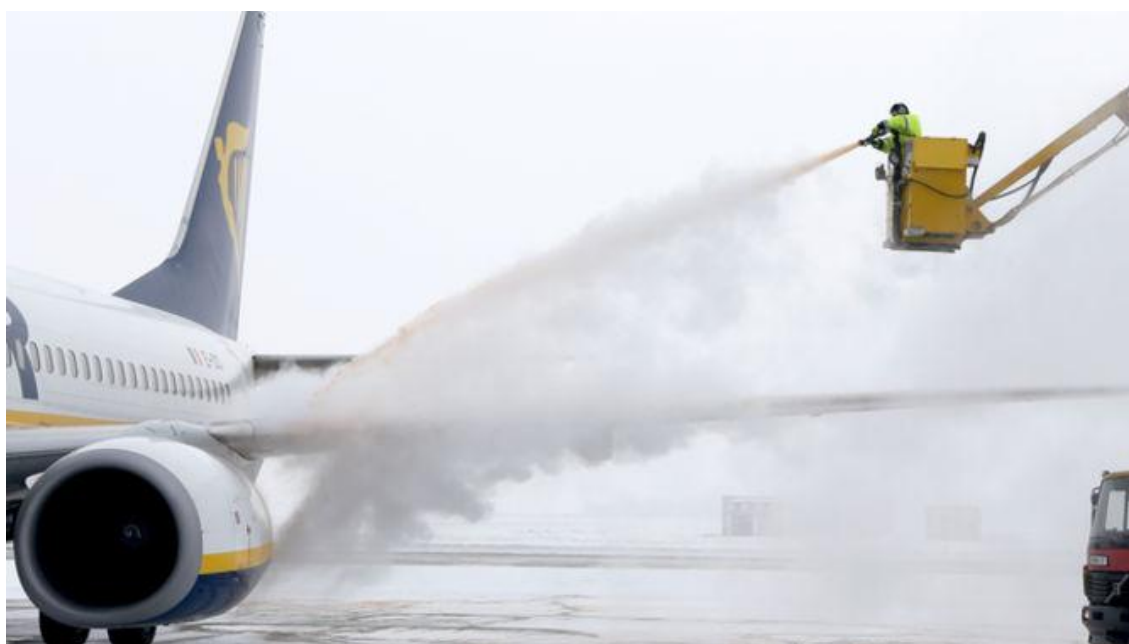
Obr. 28 - Proces odmrazovania a ochrany proti námraze
