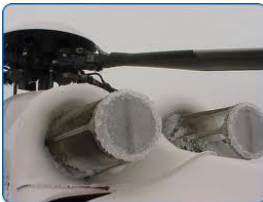
Obr. 31 - Zamrznuté výstupy motora vrtuľníka
