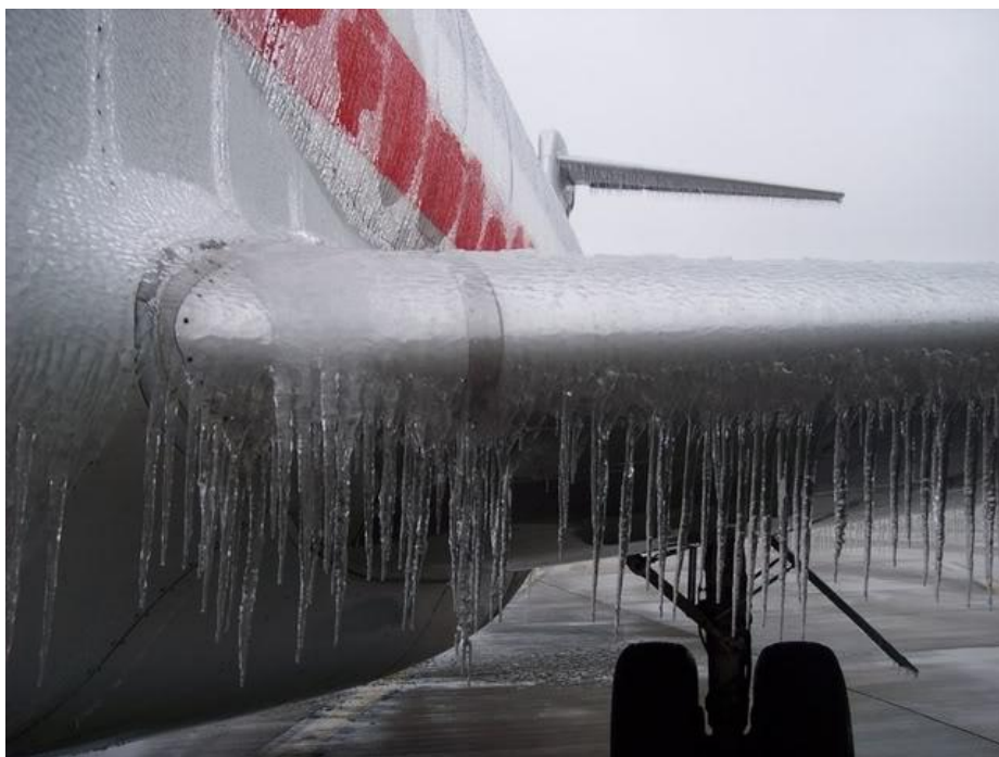
Obr. 8 - Stojace lietadlo pokryté hrubou vrstvou ľadu
