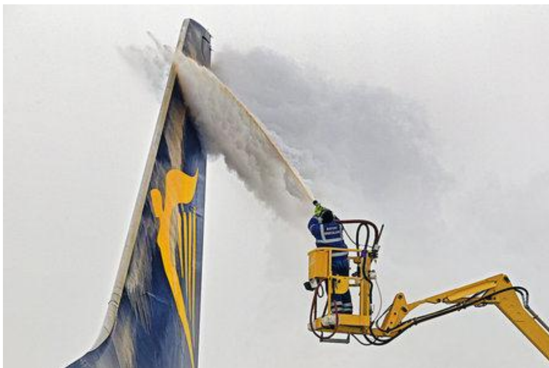
Obr. 29 - Ošetrovanie povrchu chvostovej časti kvapalinou II. typu
