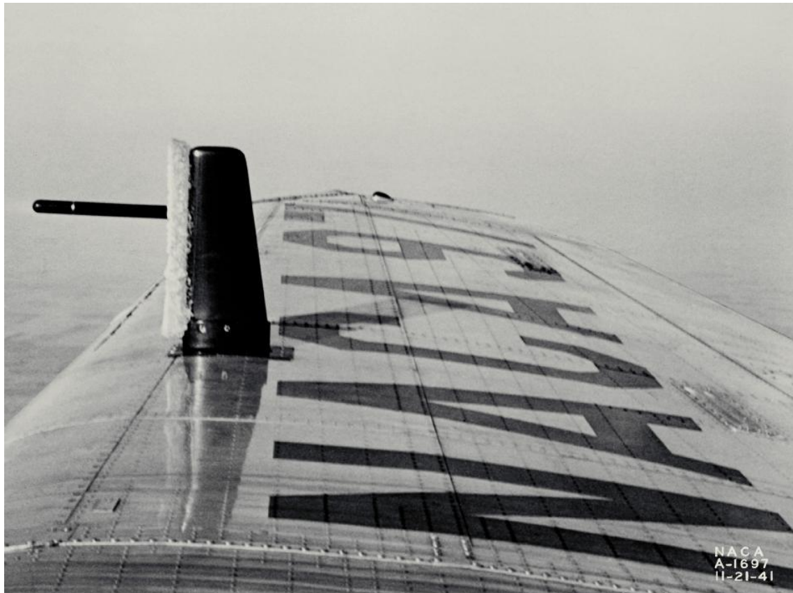
Obr. 23 - Námrazomerná sonda na krídle lietadla
