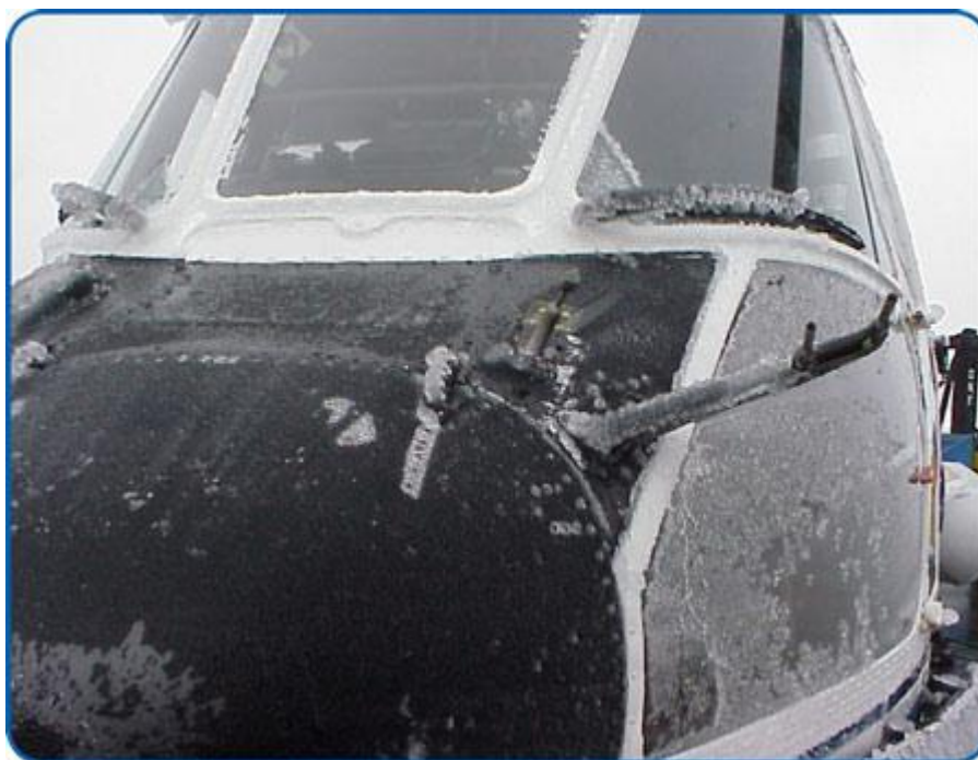
Obr. 30 - Kabína vrtuľníka po prelete mrznúcou hmlou
