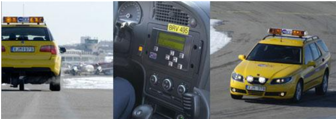
Obr. 25 - Meracie vozidlo zo zabudovaným skidometrom
