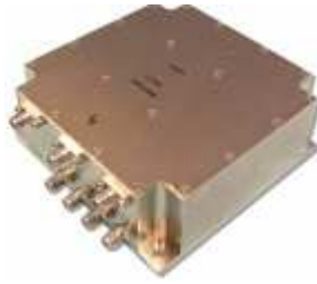
Obr. 2: Modul násobiče kmitočtu s volitelným násobitelem Spektrum microwave x4, x8 frequency multipliers
