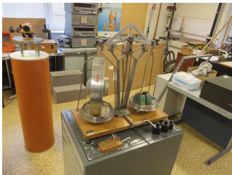
Obr. 6.3 Vážení antény Leica AT504 (autor Radim Kratochvíl)
