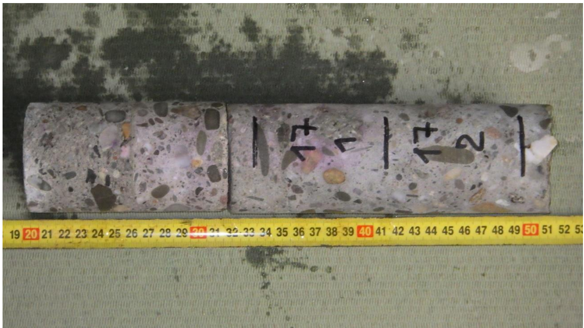
Obr. 2 Popis a změření vývrtu.
