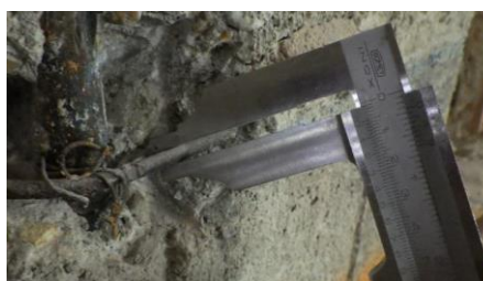
Obr. 117 Měření průměru třmíneků sloupu v rámci sondy S1.4 posuvným měřítkem
