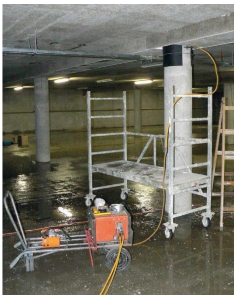
Obr. 10 Provádění radiografie pomocí zářiče \text{Co60} uloženém v krytu [11]
