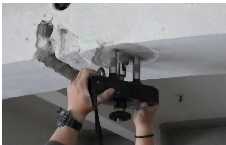
Obr. 9 Provádění měření pomocí odtrhoměru Proceq Dyna Z-216
