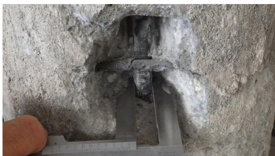
Obr. 107 Měření průměru hlavní nosné svislé výztuže sloupu v rámci sondy S1.3 posuvným měřítkem
