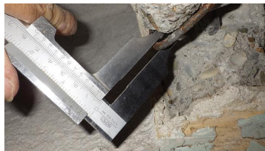
Obr. 199 Měření průměru třmínku žebra v rámci sondy T2.2 posuvným měřítkem
