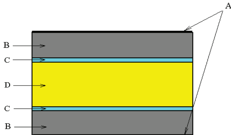
Obr. 8.1 Uspořádání membránových elektrod DMFC [4]
