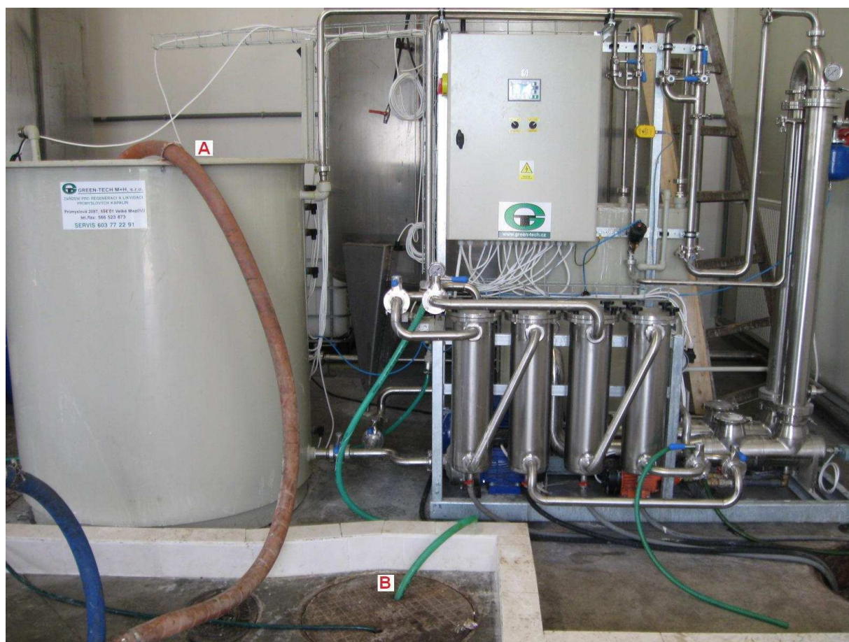
Obrázek č. 4 – Zařízení ultrafiltrace používané k čištění OV ve výrobním závodě Dermacol.
