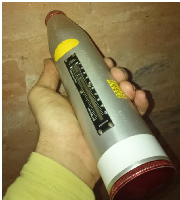
Obr. 1 Ukázka nedestruktivního zkoušení tvrdoměrem
