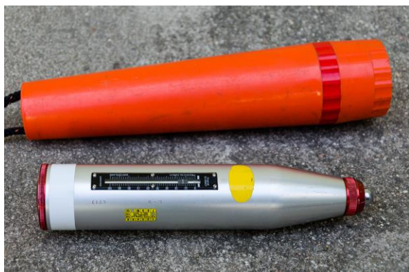
Obr. 4 Ukázka tvrdoměru Schmidt LB
