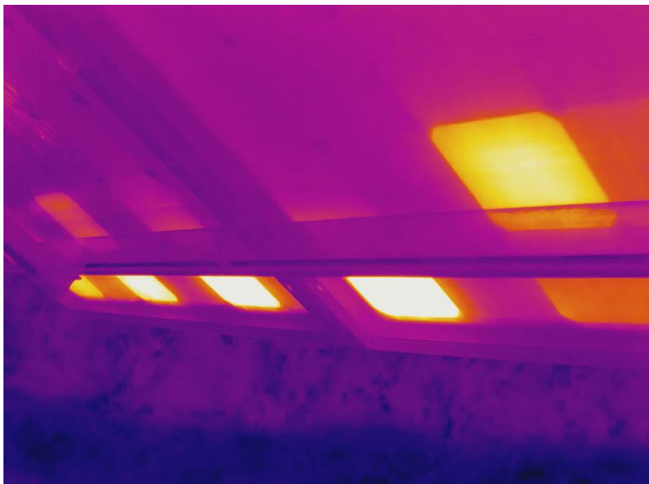
Obrázek 5-6 Detekování hotspotů termokamerou Hikmicro M60 ze zadní strany
