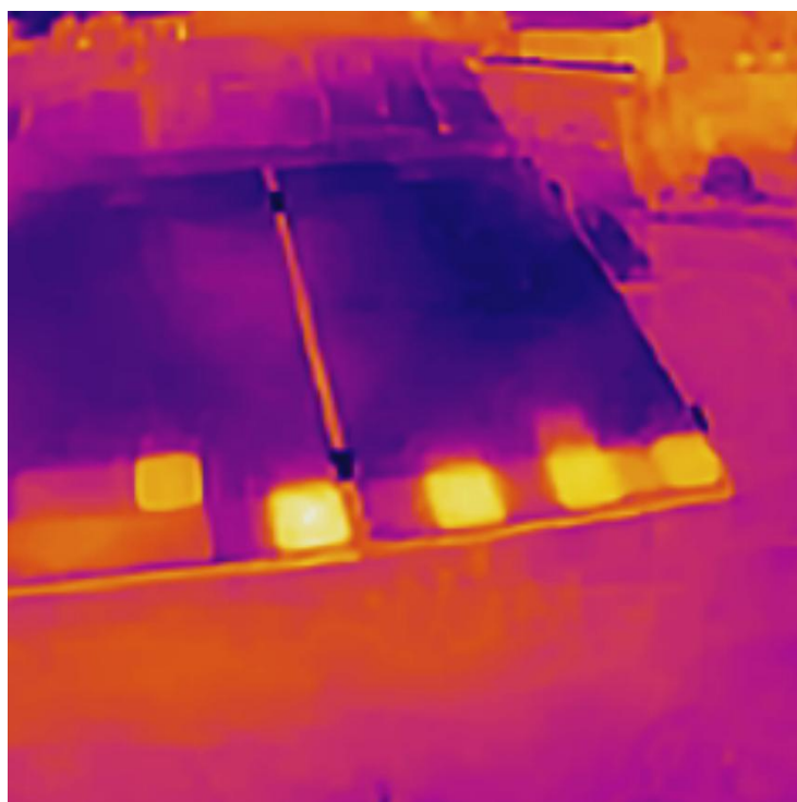
Obrázek 5-11 Detekování hotspotů termokamerou Hikmicro Eco z přední strany
