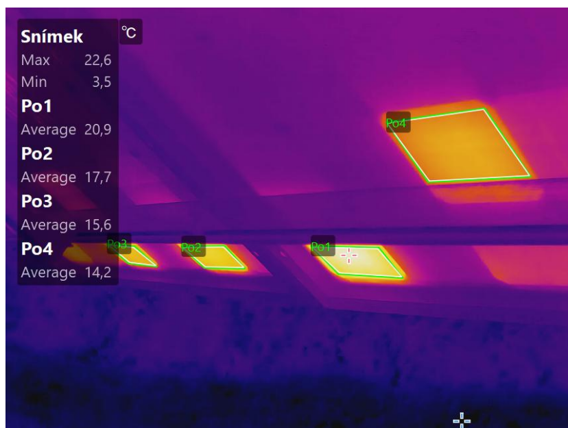
Obrázek 5-14 Analýza snímku z termokamery Hikmicro M60
