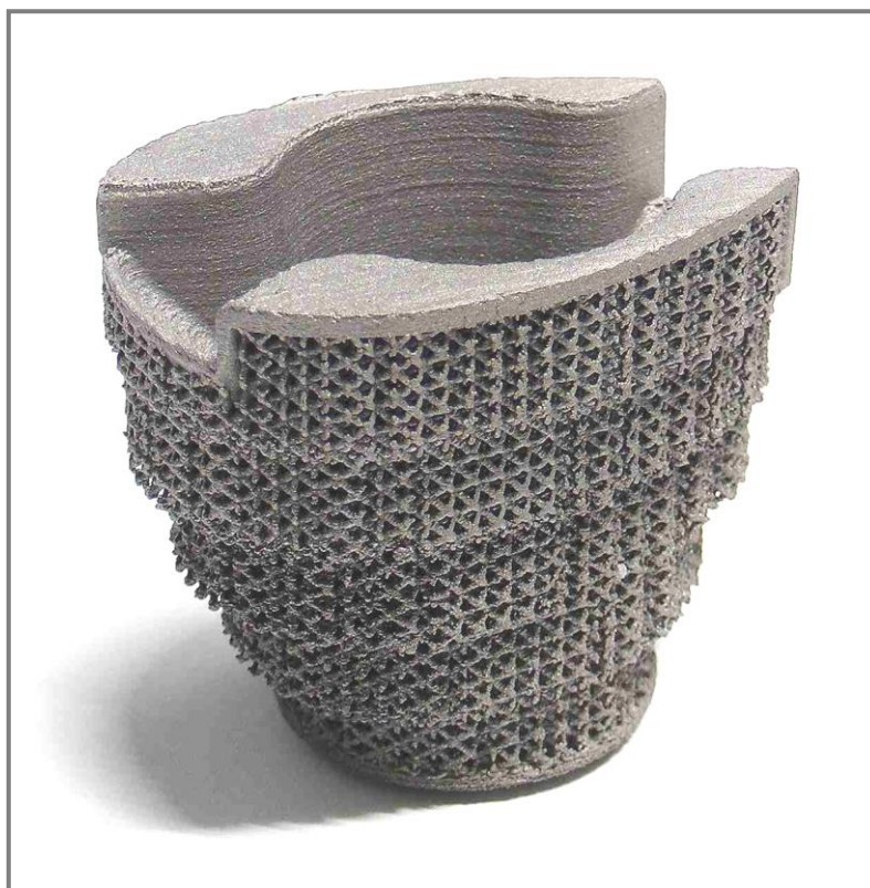
Obr. 5-14 Augmetnace po odřezání z platformy a očištění podpor 1/2
