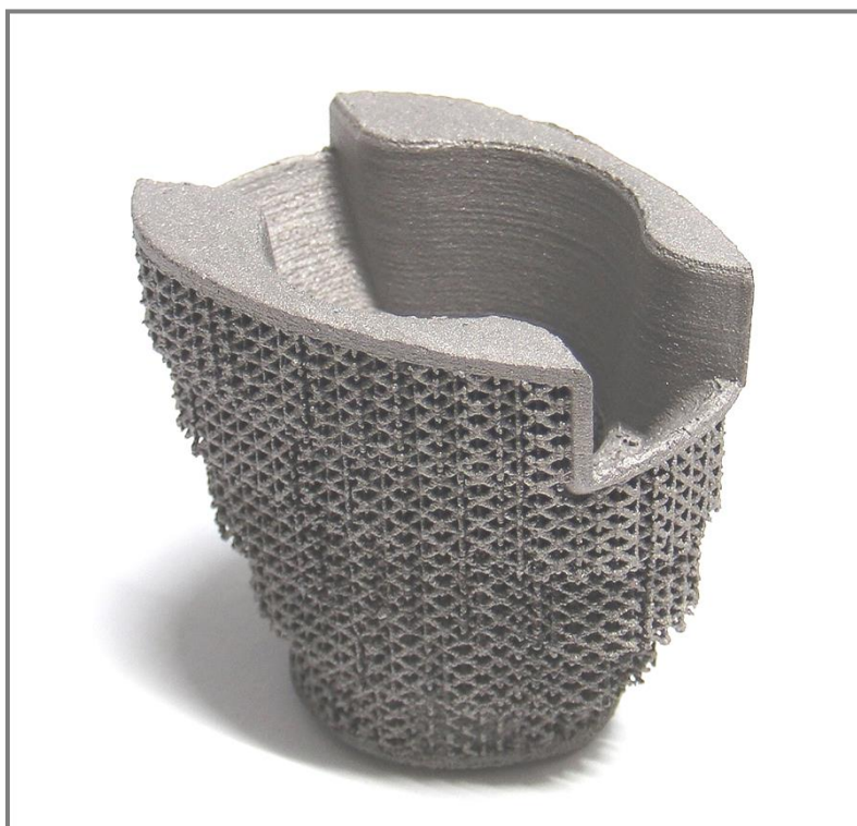
Obr. 5-15 Augmetnace po odřezání z platformy a očištění podpor 2/2
