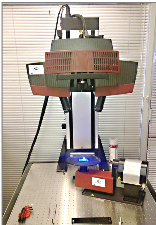
Obr. 4-10 Měřicí aparatura využitá pro digitalizaci těles
