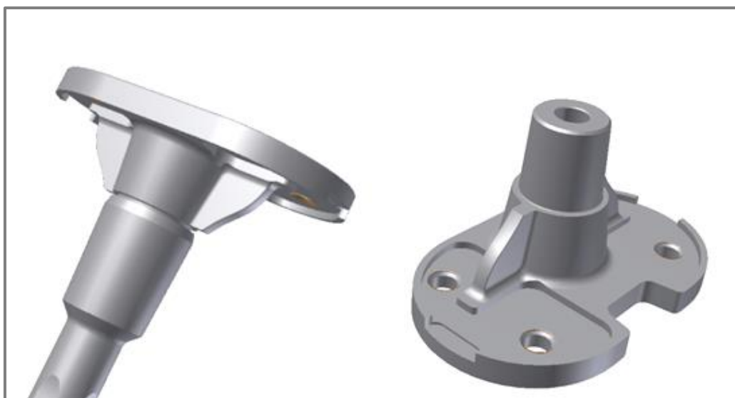
Obr. 4-47 Vizualizace modelu implantátu - typ s offsetovým prvkem [34]
