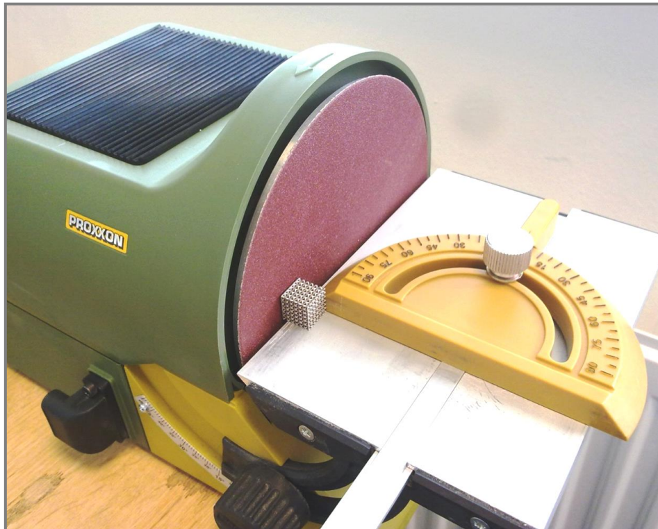
Obr. 4-35 Příprava vzorku na tlakovou zkoušku
