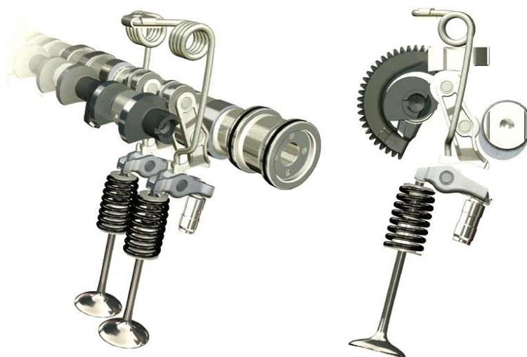
Obr. 22 Systém variabilního časování Valvetronic [29]
