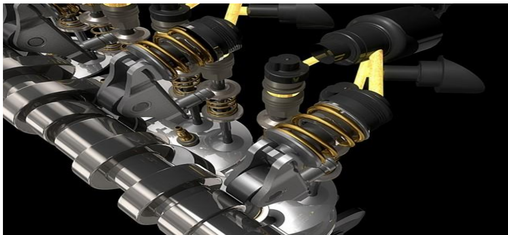
Obr. 20 Časování zdvihu ventilů MultiAIR [28]
