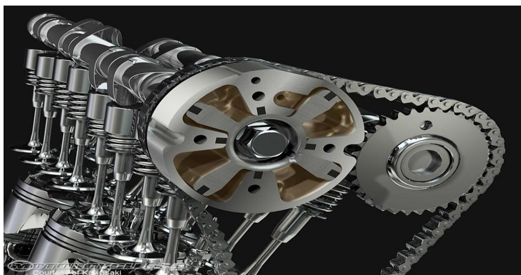
Obr. 16 Systém variabilního časování CVVT [22]
