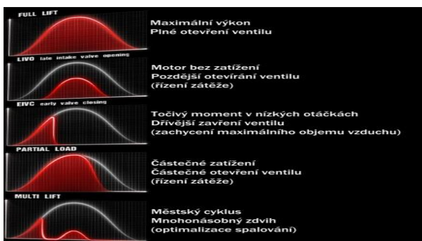
Obr. 21 Pracovní Režimy MultiAir [28]
