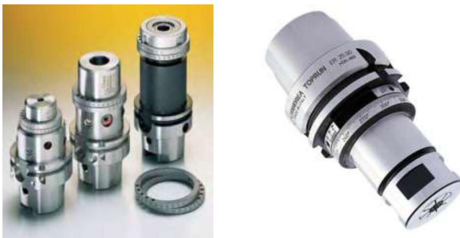
Obr. 79: Různé typy vyvažování nástrojů pomocí prstenců a pomocí segmentů
