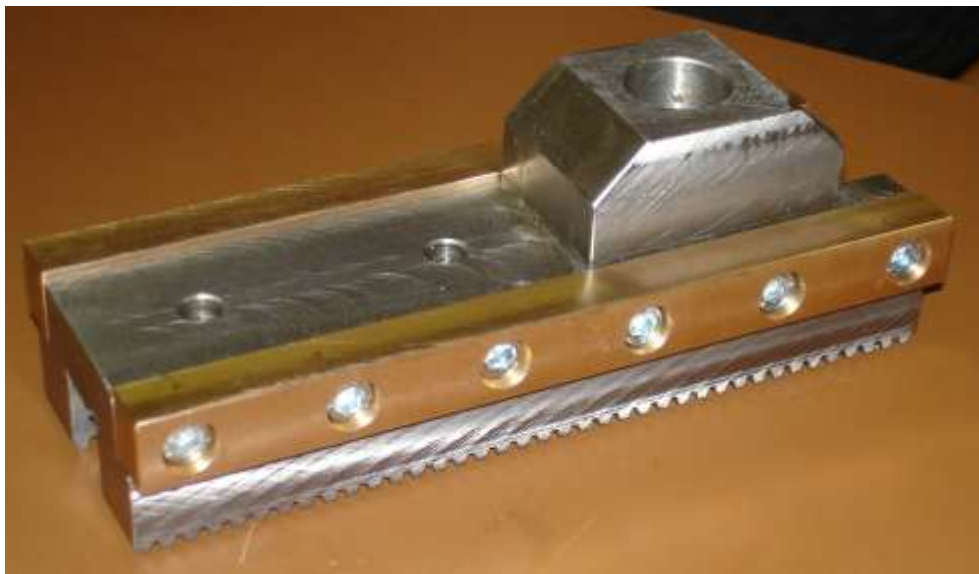
Obr. 163: Modifikované vedení hřebenu rotace vačkového manipulátoru
