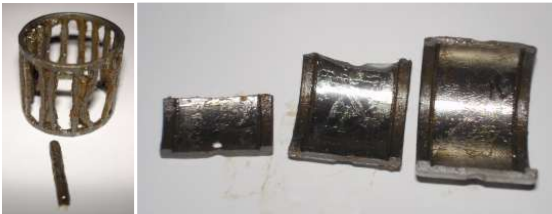
Obr. 165: Destruovaný vnější kroužek kladky a klec
