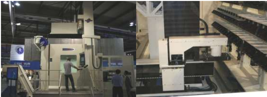
Obr. 27: Regálová AVN s plošně vertikálním rozmístěním nástrojů firmy TOSHULIN sloužící jak pro výměnu nástrojů, tak i hlav
