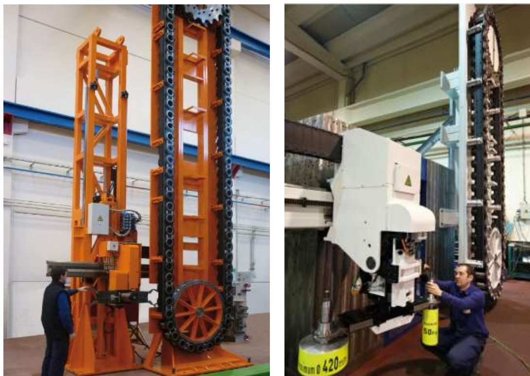
Obr. 43: Řetězové zásobníky s manipulátory pro výměnu velmi velkých nástrojů [28]
