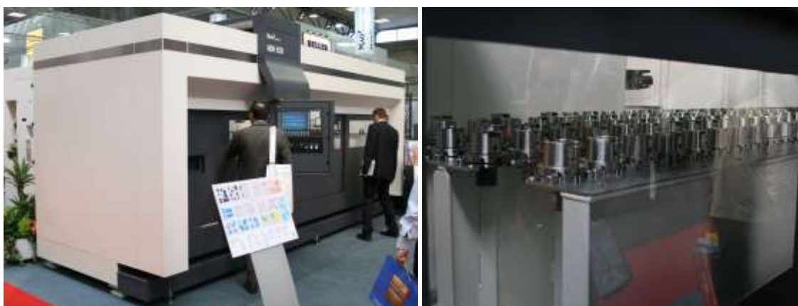
Obr. 30: Modulární regálová AVN s plošně horizontálním rozmístěním nástrojů s vertikální osou firmy MAG
