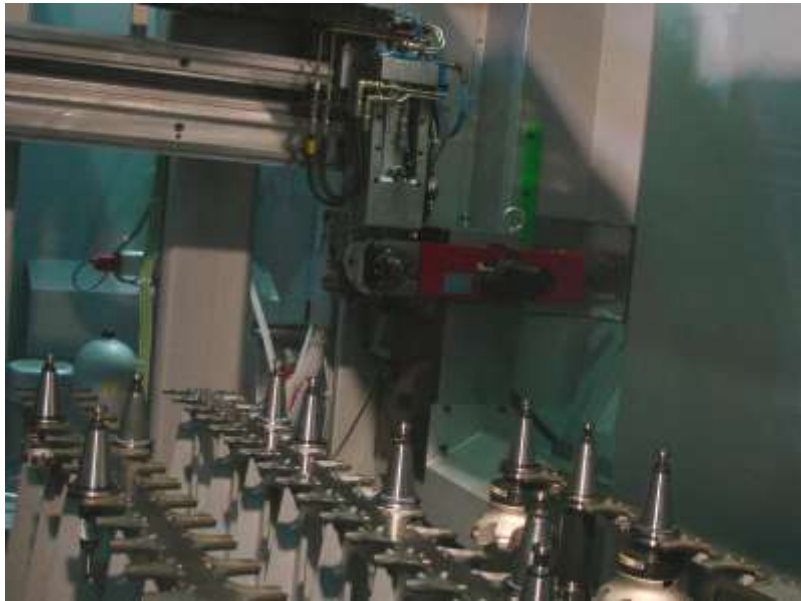
Obr. 24: Regálová AVN s plošně horizontálním rozmístěním nástrojů a vertikální orientací osy firmy Hüller
