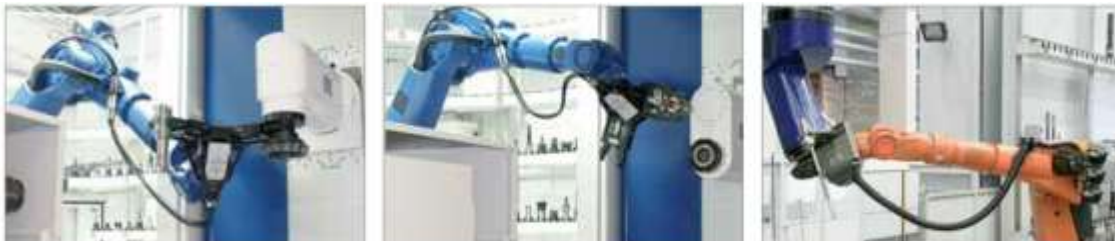
Obr. 44: Výměna nástroje pro libovolnou orientaci vřetene [51]
