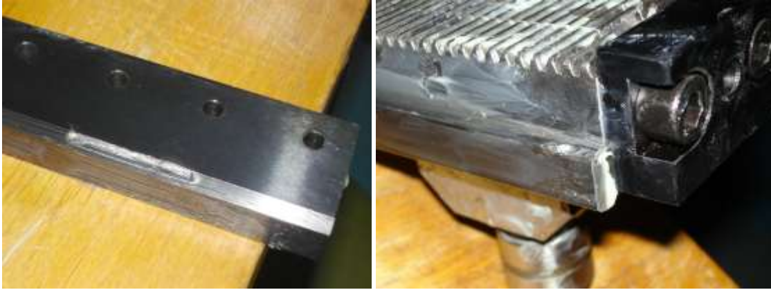
Obr. 162: Zadírání komponent hřebene rotace
