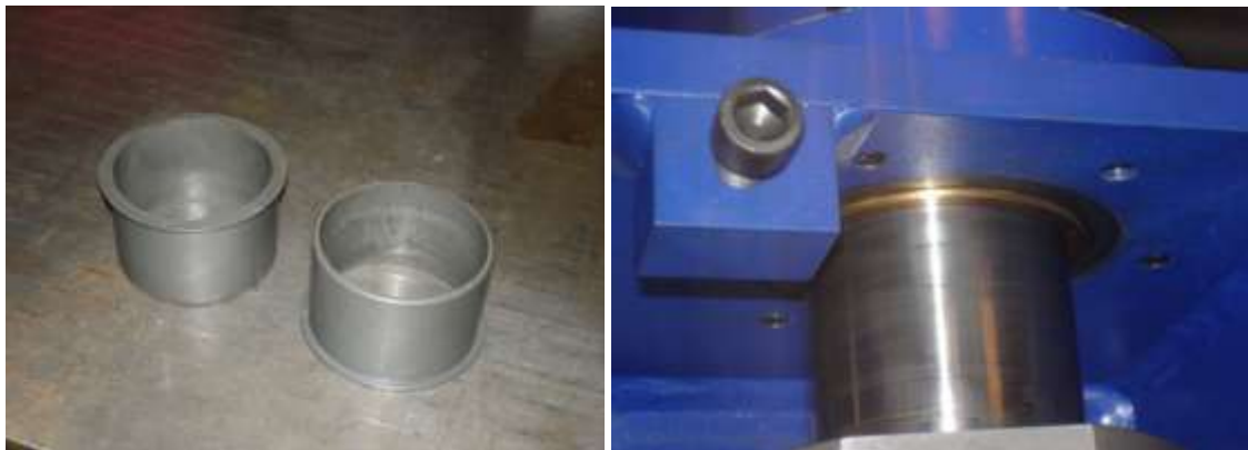
Obr. 105: Vlevo původní plastová kluzná ložiska, vpravo nové bronzové
