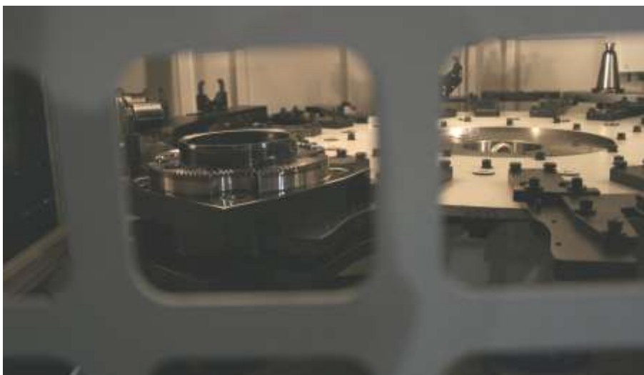
Obr. 56: Rotační PICK-UP s výměnou hlav i samostatných nástrojů
