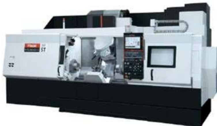
Obr. 33: Multifunkční centrum řady Integrex firmy Mazak s AVN pro 20 nástrojů [14]
