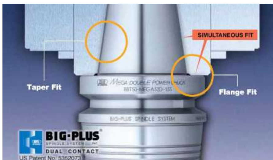
Obr. 70: Dvojitý kontakt systému BIG-PLUS [46]
