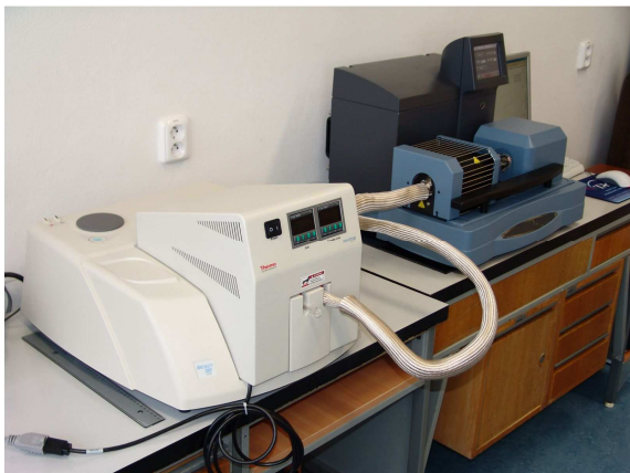
Obr. 2: Simultánní termická analýza Obr. 3: SDT Q600 - detail pírky a vahadel SDT Q600 (v pozadí) společně s propojením s kelímky na vzorky na infračervený spektrometr Nicolet 380
