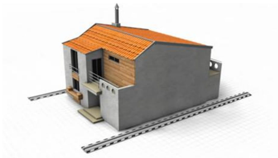
Obr. 2.6 Dům vytvořený pomocí aditivní technologie [24].
