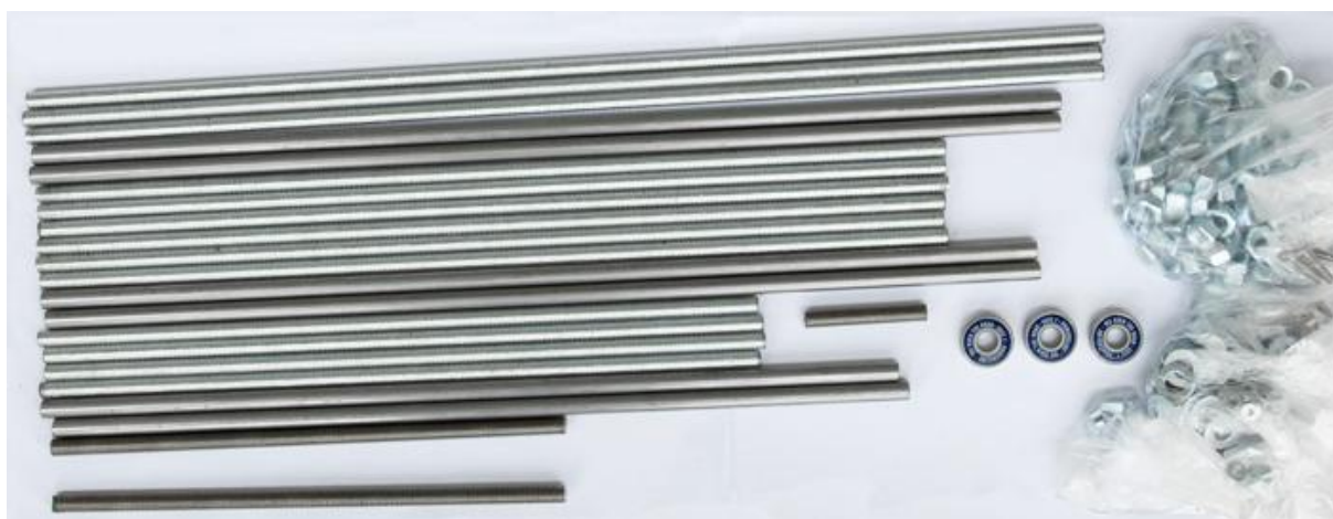
Obr. 3.4 Ocelový materiál používaný při stavbě domácí 3D tiskárny [37].
