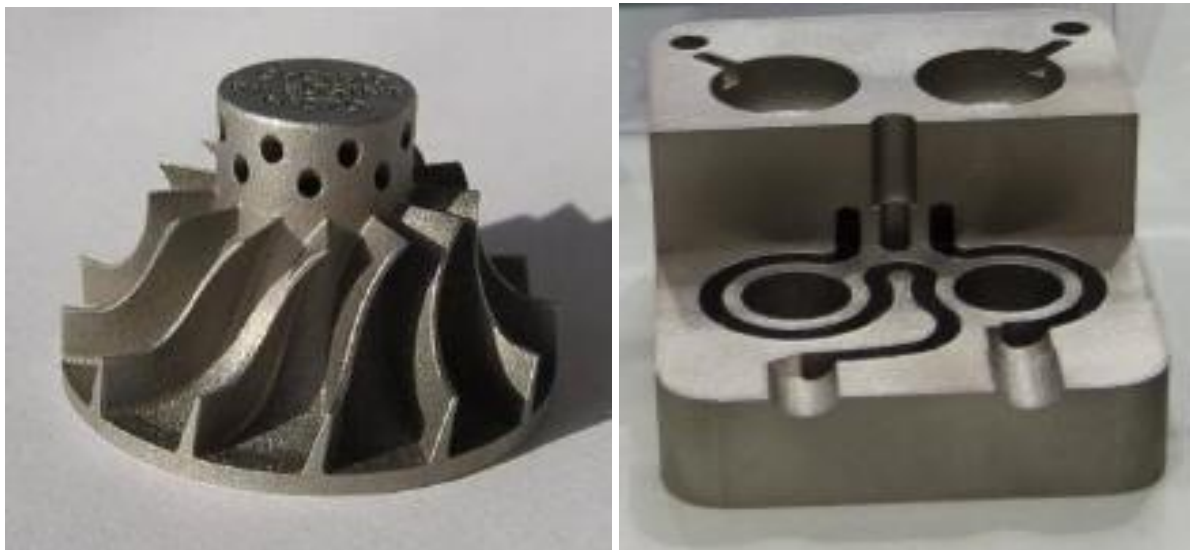
Obr. P4.2 Prototypové díly vyrobené technologií DMLS. Vlevo prototypový díl z kobalt-chromu, vpravo řez vložkou s vnitřním chlazením z martenzitické oceli [7].
