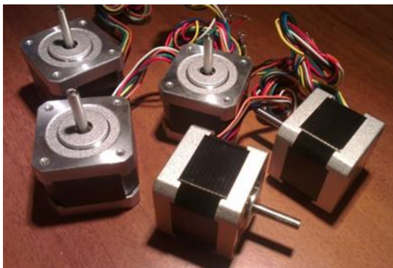
Obr. 3.5 Krokové motory SX17-1005.
