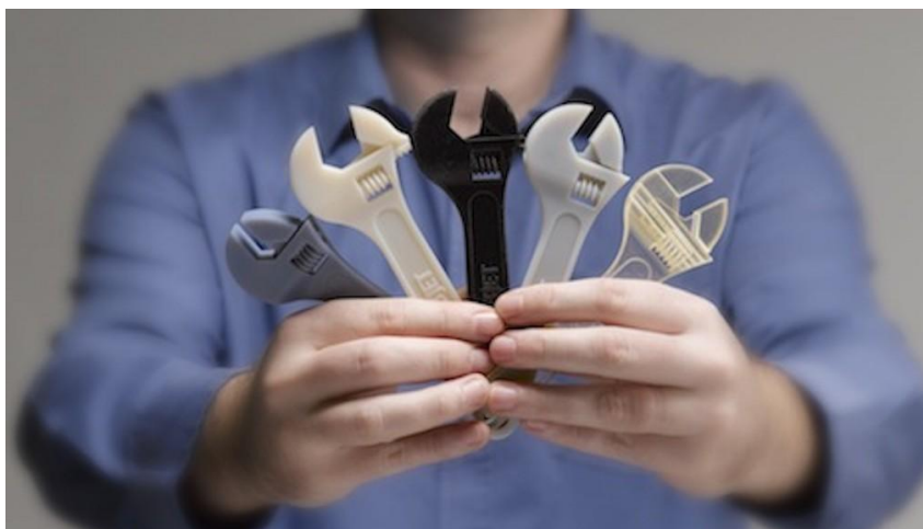
Obr. 2.8 Tisk nářadí pomocí aditivní technologie [27].
