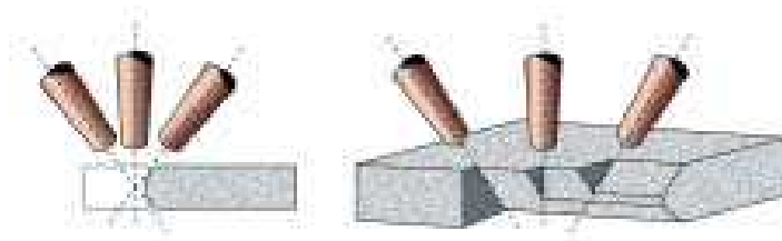
Obr. 6.3 K-tvar, uhel sražení 20°-45°, tloušťka plátu 20-75 mm [6]
