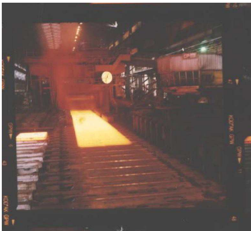
Obr. 3.6 Válcovací trať připravující pláty oceli pro výrobu trupů [8]
