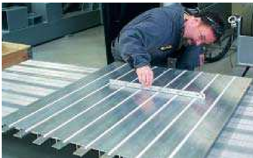
Obr. 6.2 Kontrola rovinnosti svařovaného panelu [6]
