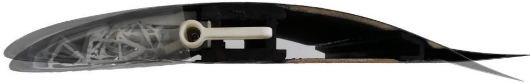
Obr. 15 Poddajný mechanismus náběžné hrany ve dvou stavech morfování, jehož tvar byl získán topologickou optimalizací (Reinisch et al., 2021)
