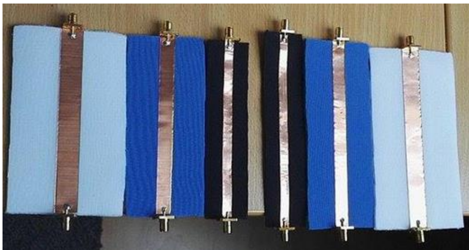
Obrázek 2.10 Vyrobené mikropáskové vedení – vlevo vedení LINE, vpravo vedení THRU
