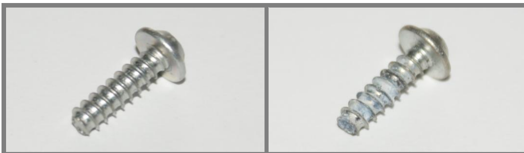
Obr. 23 Šroub L1 před a po TKO
