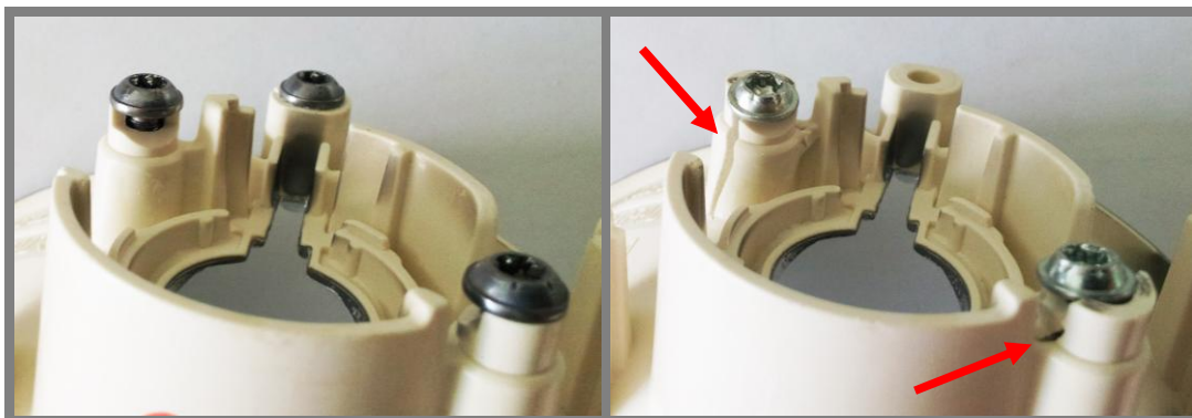
Obr. 33 Prasknuté výstupky pro šrouby
