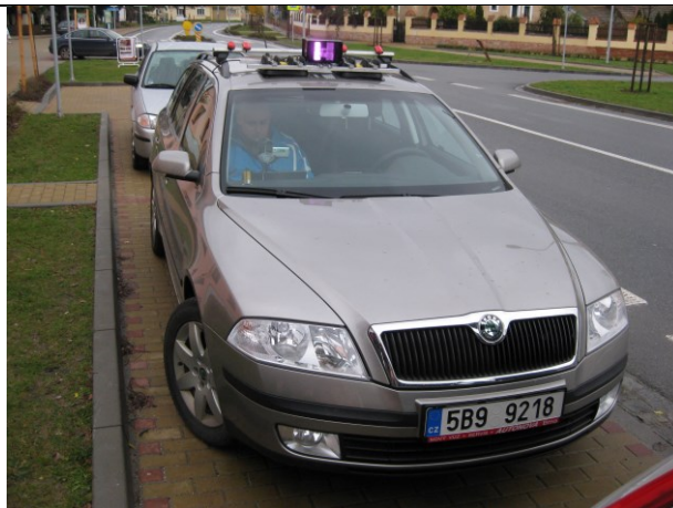
Obr. 5 Vozidlo Škoda (F_H7) s připevněným IR světlometem pro zajištění kvalitního záznamu IR kamerou
