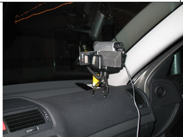
Obr. 6 Pevná kamera pro vyhodnocení okamžiku průjezdu vozidla kolem figuranta
