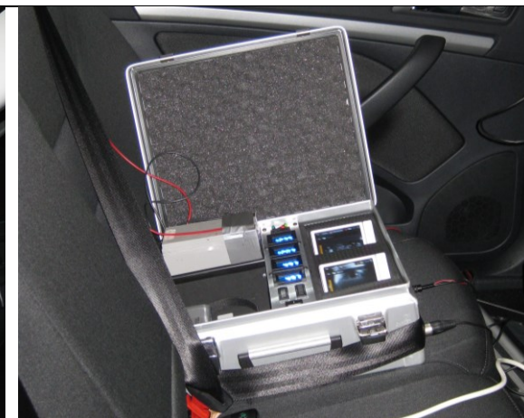
Obr. 7 Dataloger HOLUX M-241, mj. zajišťující synchronizaci záznamů přístrojů v jednotném čase
