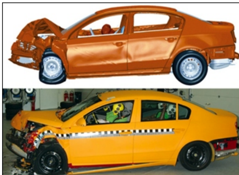
Obr. 12. Výsledek simulované a skutečné bariérové zkoušky..
