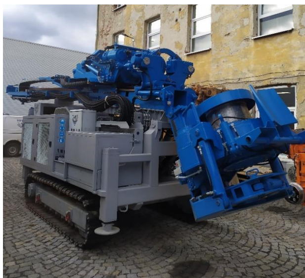
Obr. 11 Vrtná souprava s rotačním stolem od firmy JaNo s.r.o. – zdroj vlastní
