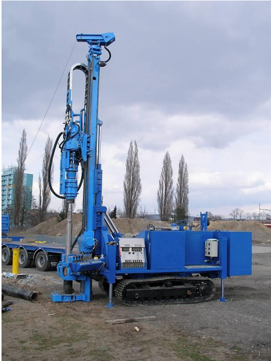
Obr. 5 Vrtná souprava na pásovém podvozku [77]
