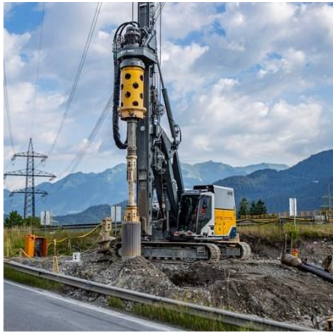
Obr. 4 Vrtná souprava jako rypadlo na pásovém podvozku s otočí [68]
