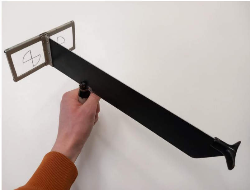
Obr. 4-3 Rémyho separátor (původní zařízení).
