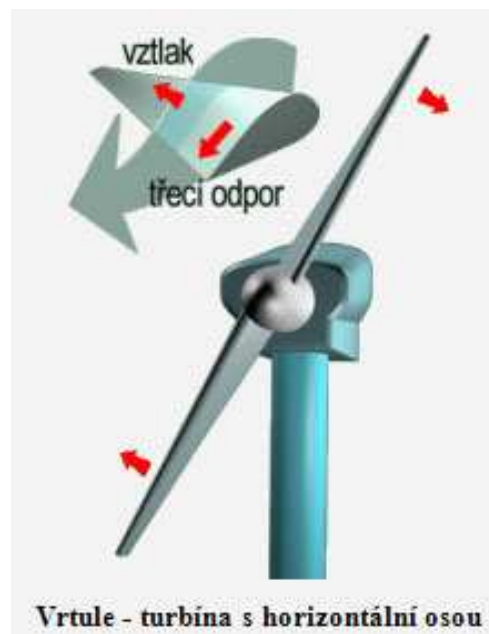
Obr. 6.2 Princip činnosti motoru s vodorovnou osou otáčení [11]
