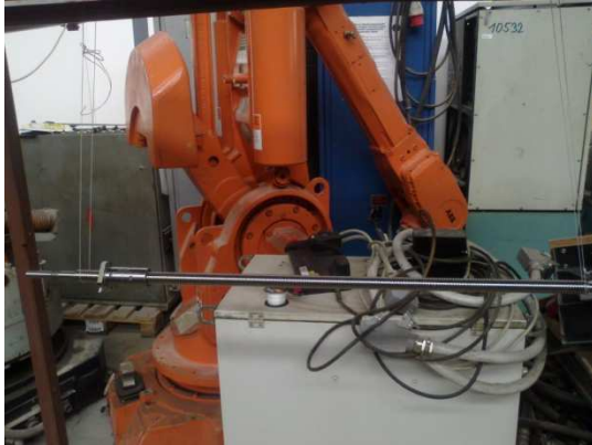
Obr. 15 Zavěšení sestavy kuličkového šroubu
