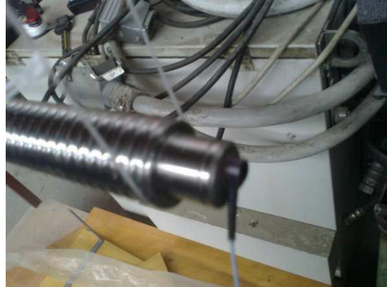
Obr. 16 Detail připevněného akcelerometru
