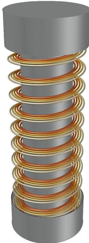
Obr. č. 15 – Model spirálovitého výměníku, metan v této konfiguraci kondenzuje v paralelně vinutých trubkách.
