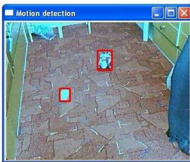
Obrázek 11: Vyhledání bílých oblastí v masce a jejich ohrazení v aktuálním snímku.
