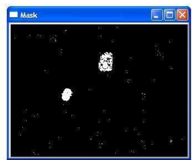
Obrázek 9: Maska po odečtení pozadí a prahování.
