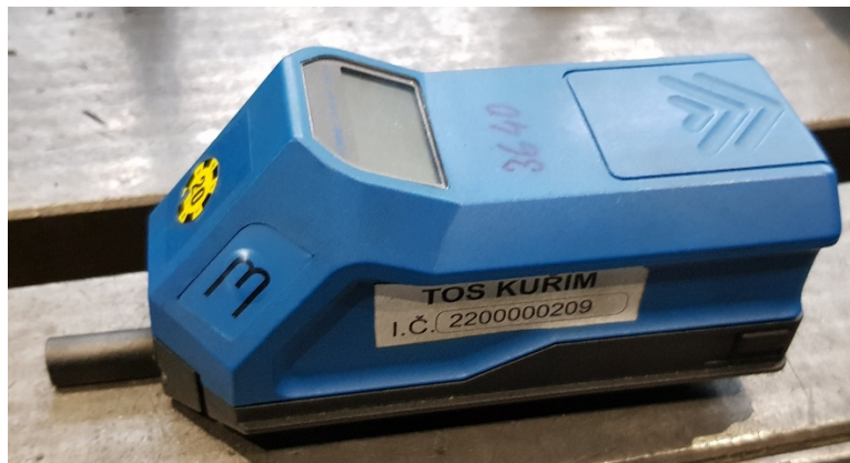
Obr. 5.9 Drsnoměr HOMMEL TESTER T500.
