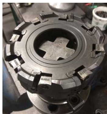
Obr. 5.3 Nástrčná čelní fréza AFOM5125R od firmy Korloy [32].
