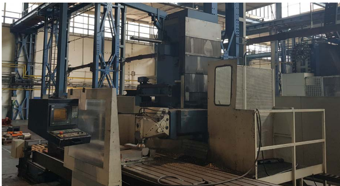
Obr. 5.2 Vertikální frézka FFQ 100 WR/A6.
