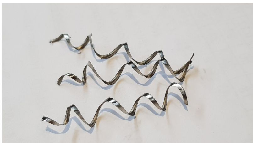
Obr. 6.12 Tříška vzniklá frézováním destičkami PRAMET.
