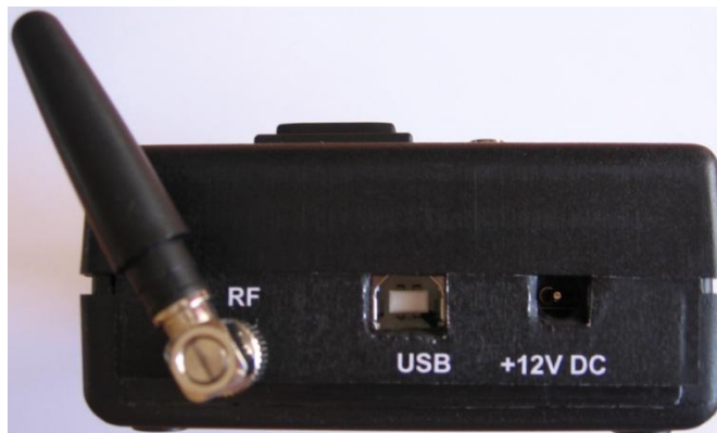
Obr. 5.8: Levý bok monitoru s řadou konektorů a připojenou anténou
