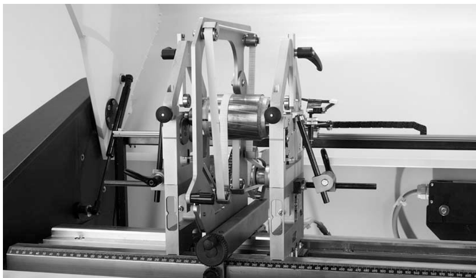
Obr. 4.7 Mechanické provedení vyvažovačky Pasio 15[10]
