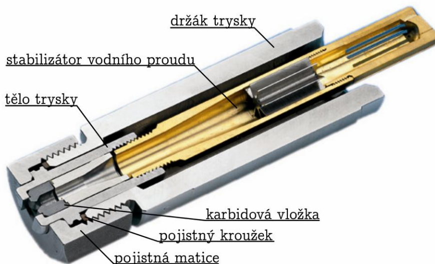
Obrázek 2.2: Konstrukce trysky [?]
