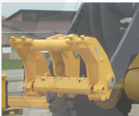
Obr.07 Rychloupínač a jeho hydraulické ovládání od firmy SAS FORKS [10]
