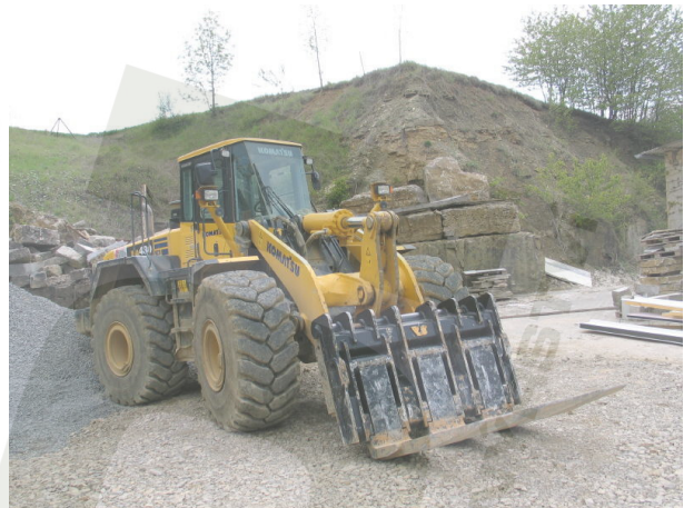
Obr.02 Uchycení pomocí třech a více horních uchycovacích háků [11],[13]
