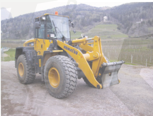
Obr.13 Rychloupínač se zajišťovacími čepy vysouványými skrz výložník nakladače [9]
