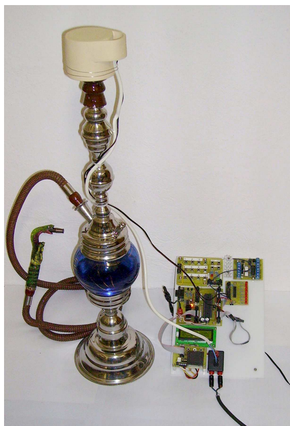
Obr. 4.4 : Vodní dýmka, na které je umístěna žhavicí komora
