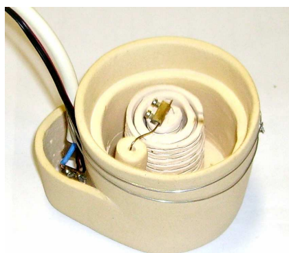
Obr. 4.2 : Válce s odporovým drátem a korunka
