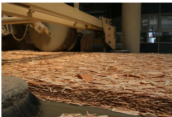
Obr. 22) Velkoplošné třísky před slisováním[22]
