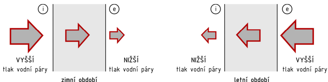
Obr. 2) Difúze vodní páry konstrukcí – princip transportu vlhkosti pro zimu a léto[zdroj: archiv autora]
