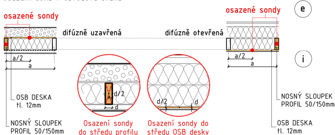
Obr. 38) Osazení sond pro měření teploty a vlhkosti ve dřevě v difúzně uzavřené a difúzně otevřené obvodové stěně [zdroj: archiv autora]
