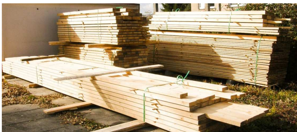
Obr. 51) Uskladněné konstrukční řezivo pro Experimentální dřevostavbu EXDR1 v průběhu vysoušení přirozenou cestou [zdroj: archiv autora]
