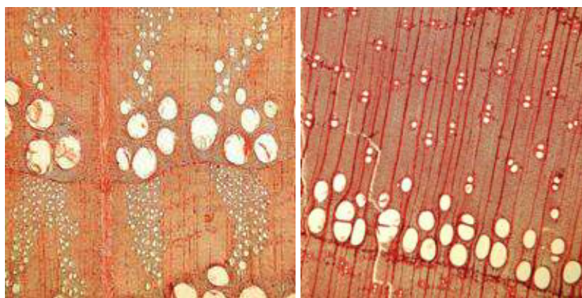
Obr. 12) Kruhovité pórovité dřeviny, příčný řez: A- dub, B – jasan; zvětšeno 40krát [36]
