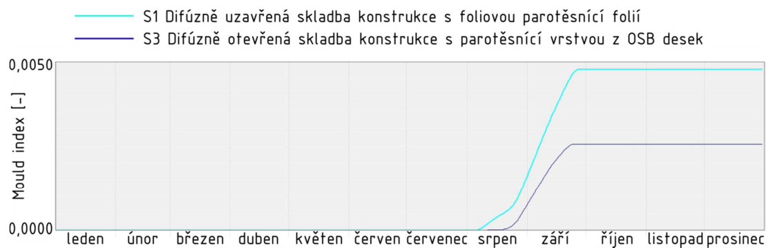
Obr. 52) Index rizika růstu plísní M stanovený pro konstrukce S1 a S3, vnitřní povrch definován jako materiál náchylný, software WUFI Bio, referenční klimatický rok ČR, zatříděno do skupiny M = 0 (bez rizika)
