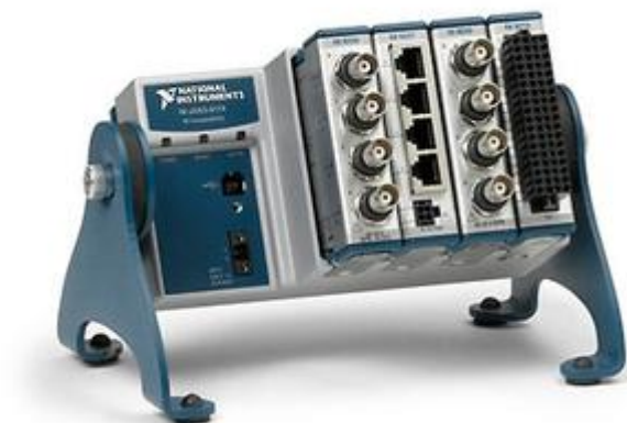
Obr. 6 - 2: NI CompactDAQ šasi a vložené měřicí karty [20]
