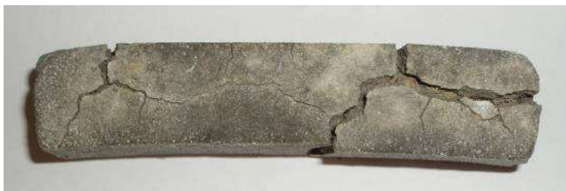
Obr. 37: Alkalické rozpínání vzorku CKD N50
