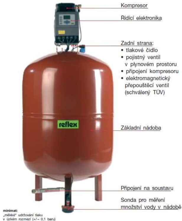
Obr. č. 52 Kompresorový expanzní automat Reflex „Minimat“ (38)
