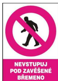
Obr. č.66 nevstupuj pod zavěšené břemeno
