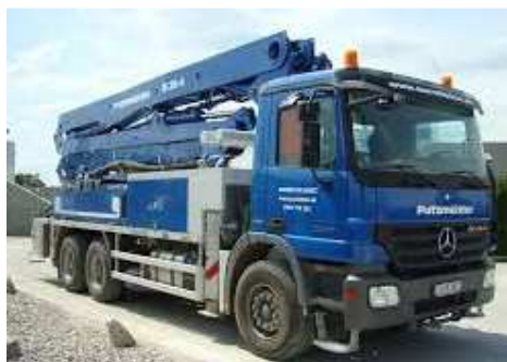
Obr. č.48 Mercedes Benz Actross 2641K s nástavbou Putzmeister M36-4
